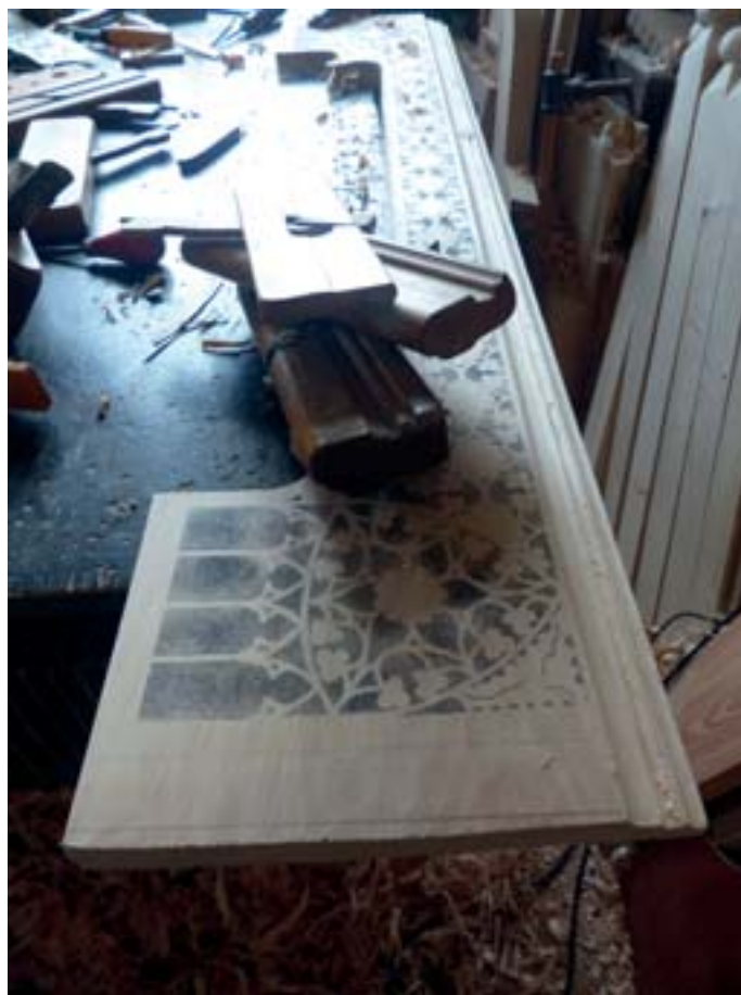
Použití profilových hoblíků – římsovníků – v praxi. Profil se musí někdy vytvořit postupným střídáním jednotlivých profilů
