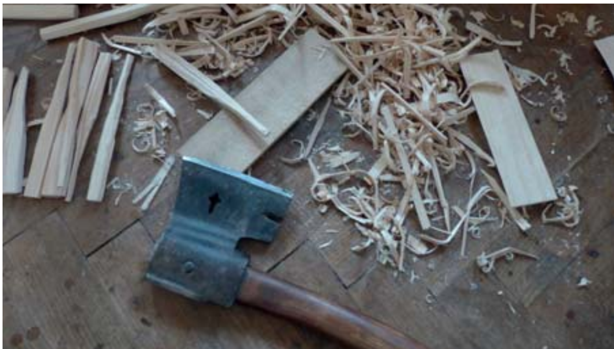
Výroba kolíčků nahrubo štípáním materiálu
