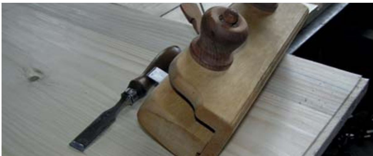
Hoblík drážkovník s předřezem a vyměnitelným želízkem různých šíří
