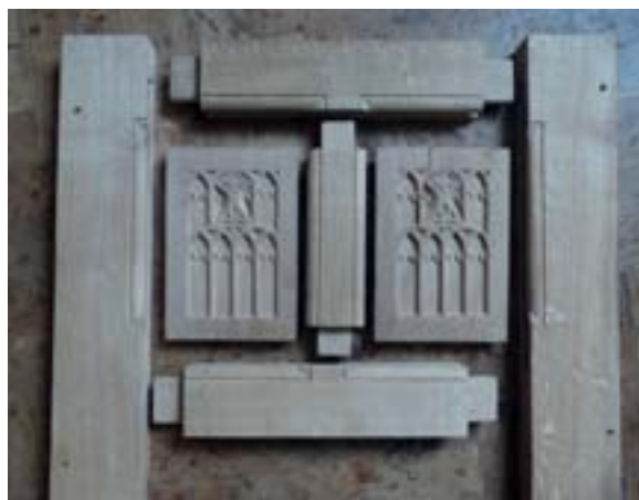
Soustava čepů a dlabů na bočnici půlpitu
