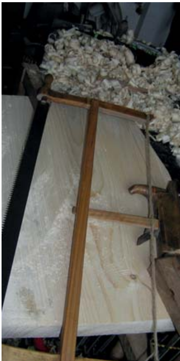
Rámová pila s hrubým listem na podélné řezání
