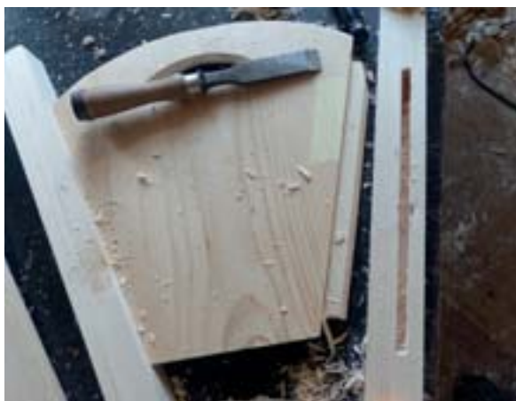
Podélný čep a dlab v konstrukci kolébky
