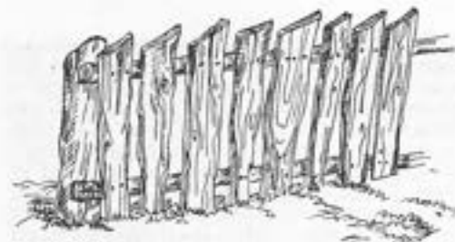
Hrazení ze šindeľových štípů nebo štípaných dřevky. Překresleno podle J. Harringera z článku J. Cedidly: Jak se na Valašsku hraďovalo. Valašsko VII (1958), str. 30.
