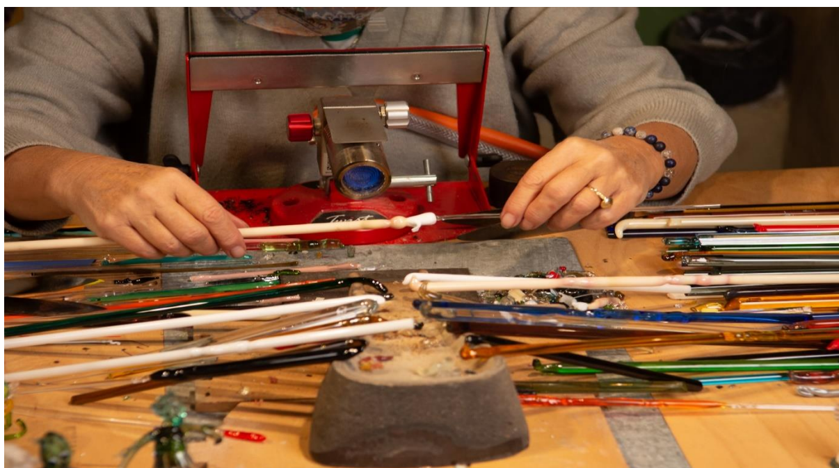
(Obr. č. 12 ) Přidání pomocné nosné tyčky zespod těla figurky.
