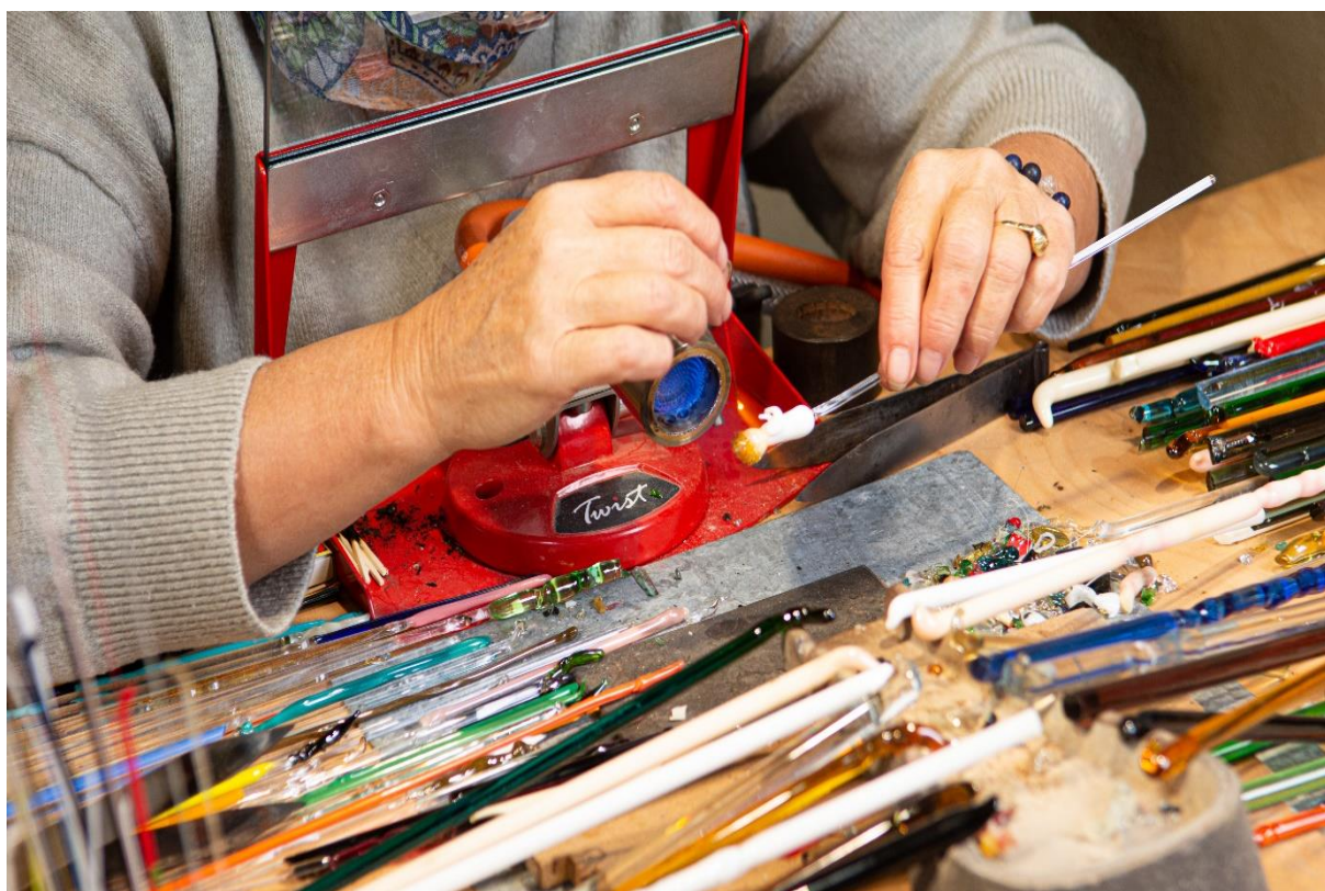
(Obr. č. 16) Detaily obličeje tvořené skleněnou tyčkou vhodného malého rozměru.
