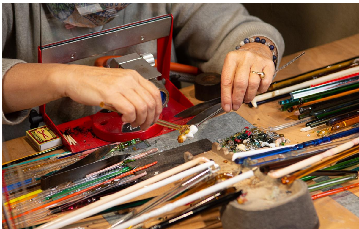
(Obr. č. 18) Připojení křídel k tělu figurky. Na stole u kahanu jsou vidět pinzety – nezbytné nástroje figurkáře.
