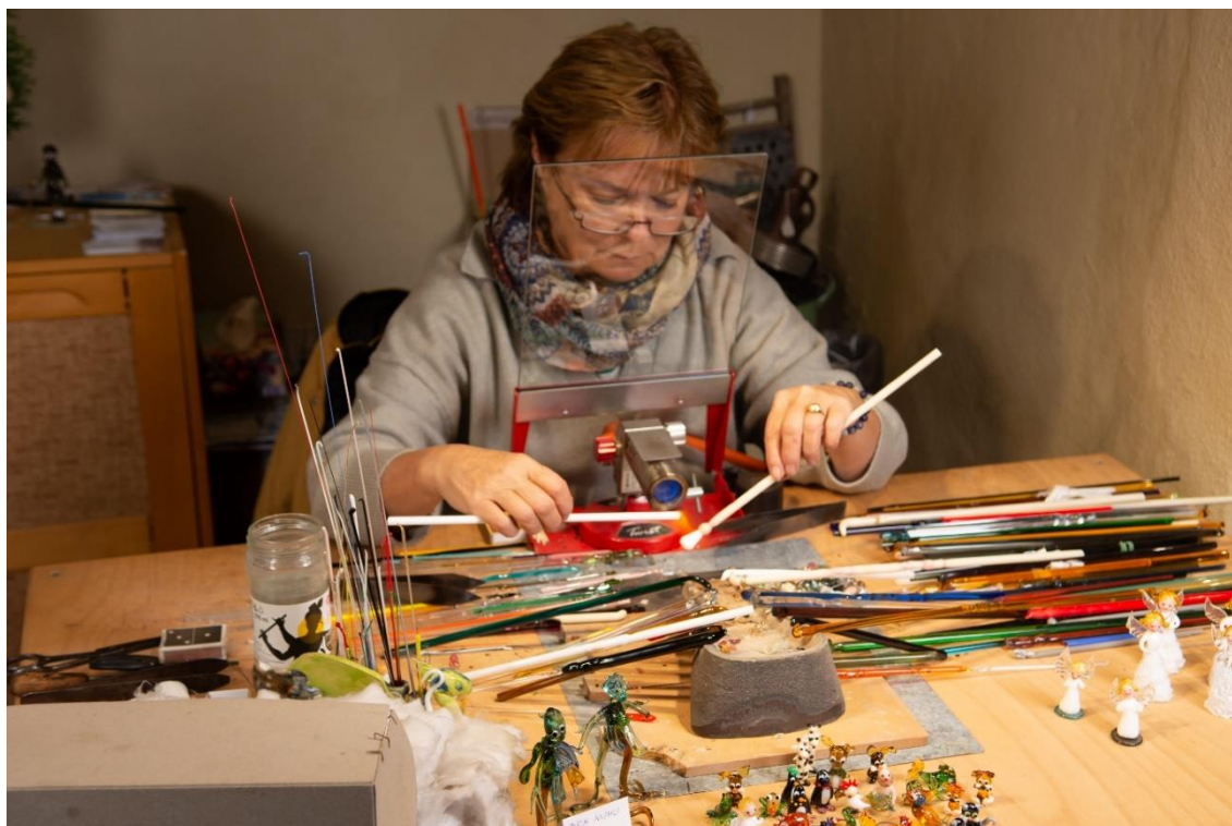
(Obr. č. 11) Hlava spolu s tělem figurky. Rozehřívání tyčoviny pro vytvoření rukou.
